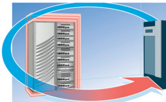
Präzisionsklimagerät: Luftleistung 300 m³/h pro kW
