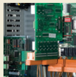
Kontroler C7000 IOC z dodatkową kartą rozszerzającą
